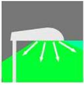
Una parte degli apparecchi di illuminazione esistenti (tutti quelli di arredo urbano ed una parte di quelli stradali) di installazione più recente, sono invece risultati adeguati, presentando buone condizioni di conservazione, schermo di chiusura piano (ottica cut-off) ed elevati rendimenti ottici (ottiche di recente costruzione) ed installati correttamente (inclinazione nulla rispetto al piano stradale).
