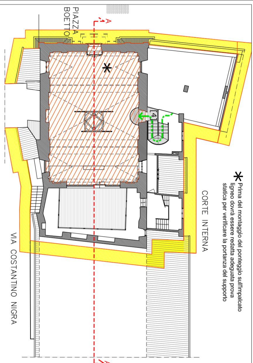
\* Prima del montaggio del ponteggio sull'impalcato ligneo dovrà essere redatta adeguata prova statica per verificare la portanza del supporto
